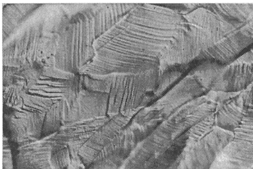
Rys. 2.31. Pasma poślizgu w austenitycznej stali chromowo-niklowej (18% Cr, 8% Ni) odkształconej plastycznie przez rozciąganie. Próbką nietrawiona. Powiększenie 800x
